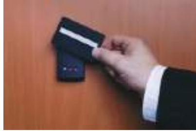
चित्र 4.1.2: दरवाजा तक पहुंच की नियंत्रण प्रणाली
